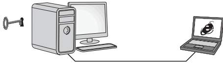
Web manager ile internet üzerinden erişimiyle tekli server mimarisi.
