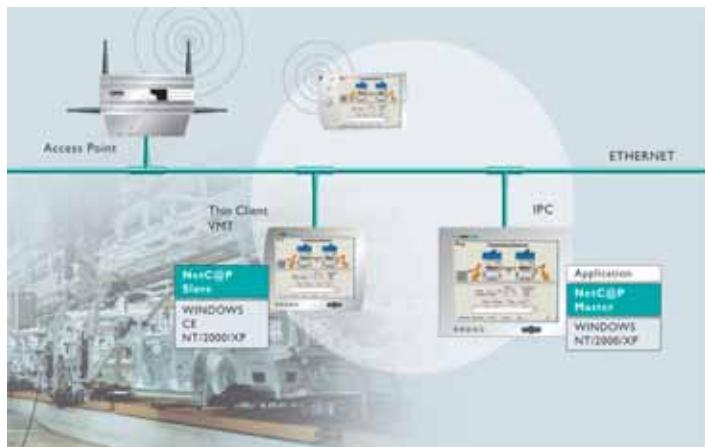
NET CAP yazılımı ile endüstriyel ekranlar 8 ekrana kadar çoğullanabilir.
