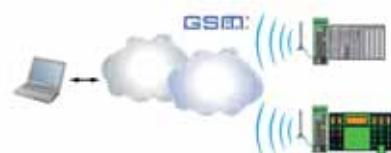
Modemler aracılığı ile ister var olan telefon hattından, ister GSM operatörlerinden PLC'nizi programlayabilir, sms ve faks özelliği ile izleme yapabilirsiniz.
